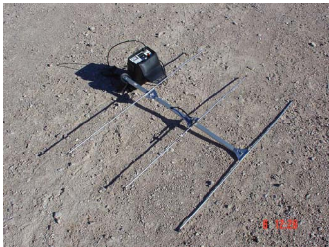
Foto nº12: Equip receptor de telemetria destinat al seguiment per ràdio dels exemplars equipats amb emissor.
