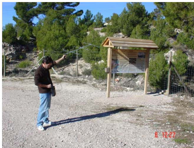
Foto nº13: L'antena direccional de l'equip receptor permet una estimació de la direcció i la distància aproximada a la que es troba l' animal.
